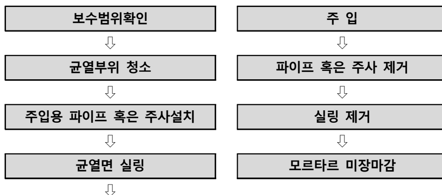
[그림 5.2.5] 주입공법의 시공순서
